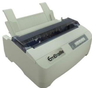
Предназначен для печати небольших тиражей документов шрифтом Брайля и тактильной графики. Принтеры различаются скоростью печати, возможностью печатать с двух сторон одновременно, разрешением, возможностью настраивать высоту шрифта, ну и конечно же ценой. Данный принтер обязательно нужно дополнить специальной программой на компьютер для печати тактильной графики и ПО транслятор текста в Брайль Duxbury Braille Translator
