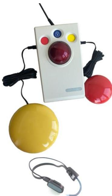
**Проводной роллер или джойстик.** Представляет собой устройство, альтернативное мыши, позволяет управлять курсором без помощи мыши, а путем перемещения джойстика или шара у роллера. На корпусе роллера размещены также кнопки, дублирующие функции правой и левой кнопки мыши. Джойстики и роллеры делают управление ПК простым и удобным для детей с ОВЗ, тк имеют высокую чувствительность и реагирует даже на легкие прикосновения.
