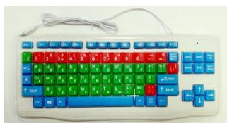
Специализированная клавиатура с крупными цветными кнопками и специальной накладкой, разделяющей клавиши для удобства набора текстов. В качестве альтернативы в некоторых более дорогих комплектах оборудования в набор входит специальная сенсорная клавиатура, удобство которой заключается в возможности расставления кнопок в нужной комбинации и последовательности. Проводная/Беспроводная на выбор. Также, по умолчанию к ПК прилагается и классическая клавиатура и мышь.
